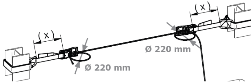
Figura 38. Distancias entre punto de sujeción y el trinquete tensor de la línea de vida horizontal portátil INNOTECH.
