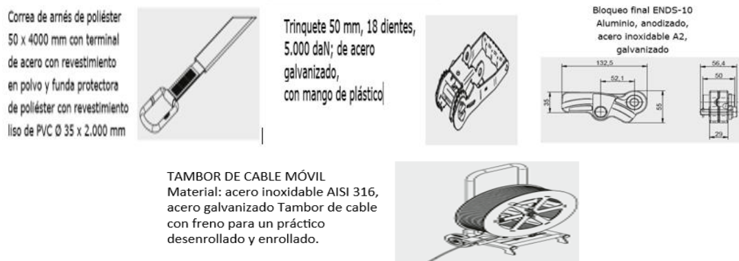
Figura 9. Componentes de la línea de vida horizontal portátil INNOTECH.
