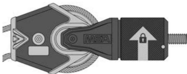
Figura 14. Tambor del cable en la línea de vida asegurado.
